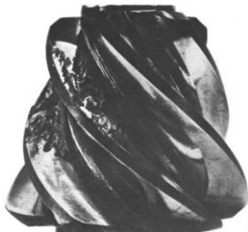
Slika 8. Oštećenje otvrdnutog boka zupca[4]
