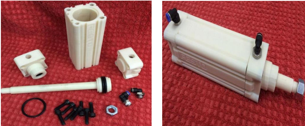
Slika 15. Izgled završenog pneumatskog cilindra koji je dobijen tehnologijom aditivne proizvodnje
