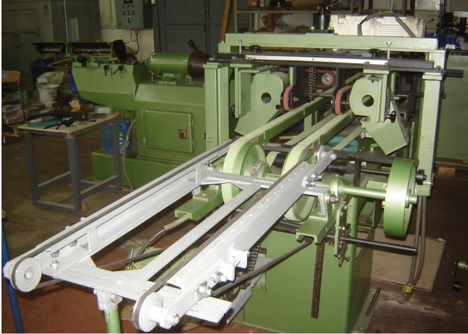
Slika 4. Izgled eksperimentalne linije za izradu obloženih elektroda
