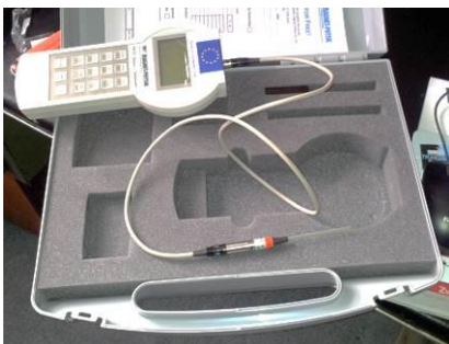
Slika 7. Prenosni uređaj za merenje magnetizma MAGNET PHYSIK FH 51
