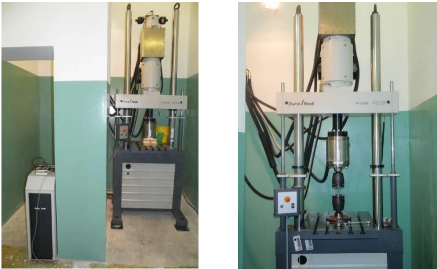
Slika 2. Servo hidraulična mašina za dinamičko i statičko ispitivanje materijala ZWICK Roell HB – 250
