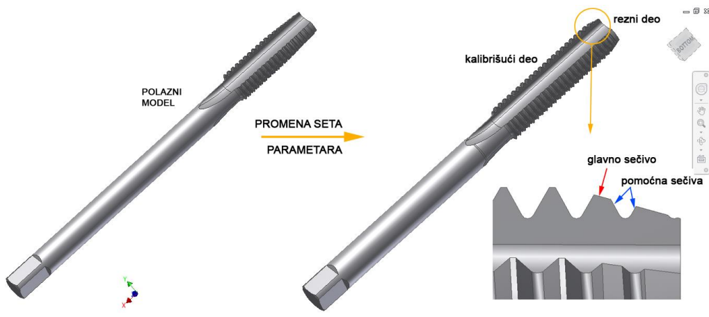
Slika 4. Parametarski definisan mašinski ureznik sa pravim žlebovima
