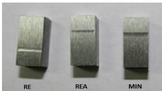
Slika 4. Tragovi habanja blokova pri tribološkim ispitivanjima
