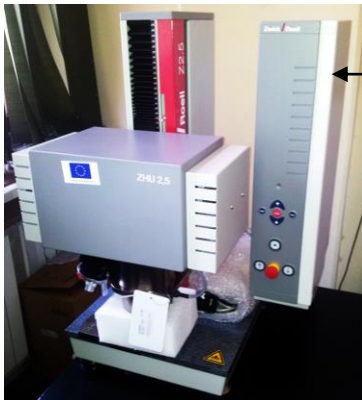
Slika 6. Stabilni i prenosni uređaj za merenje tvrdoće ZWICH ROELL ZHU 2.5 i Microdur MIC 10a
