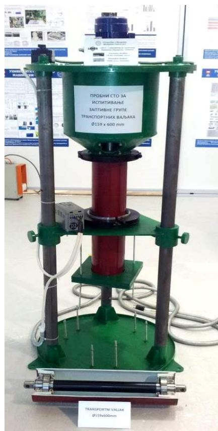
Slika 4. Probni sto za ispitivanje zaptivne grupe transportnih valjaka razvijen na Univerzitetu u Beogradu – Mašinskom fakultetu
