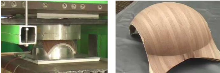
Slika 1. Tehnologija izrade 3D furnirskih ploča [8]
