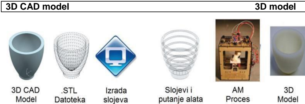
Slika 4. Principijelna šema aditivne proizvodnje
