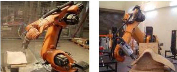
Slika 2. Profilisanje dijelova stolica od furnirskih ploča pomiću robota (KUKA) [9]
