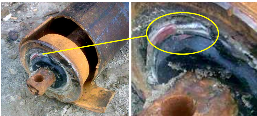
Slika 2. Primer otkaza zaptivne grupe transportnog valjka
