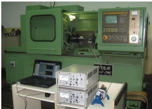
Slika 1. Prikaz obradnog i merno-akvizicionog sistema KNU struga
