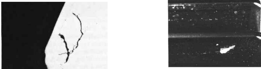
Slika 5. Ljuštenje, otcepljenje – spalling [4]
