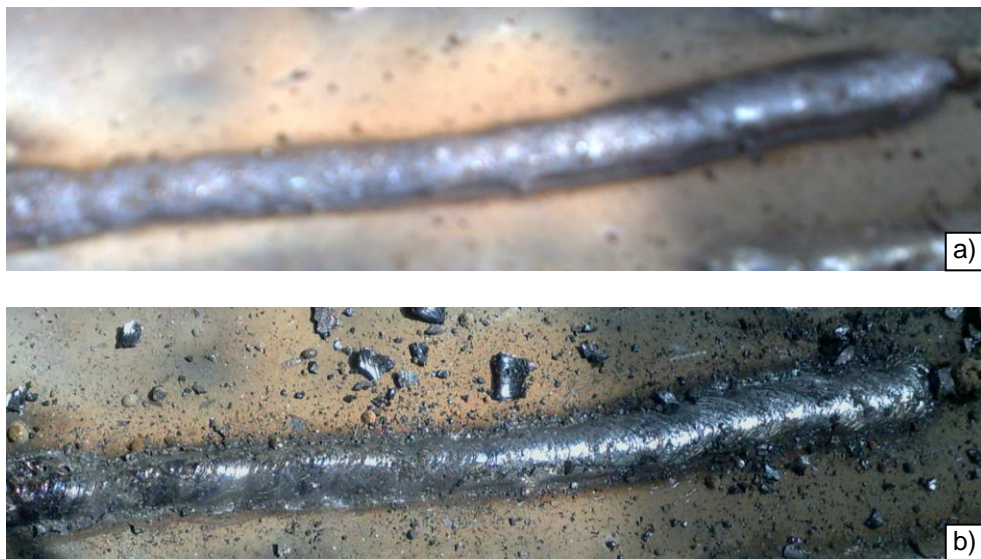
Slika 6. Izgled šava dobijenog zavarivanjem eksperimentalno izrađenim elektrodama
