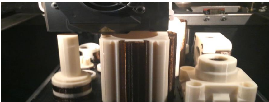
Slika 14. Elementi pneumatskog cilindra u toku procesa aditivne proizvodnje
