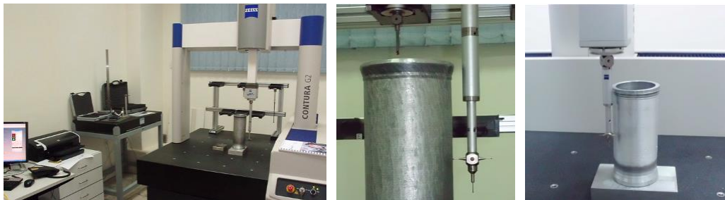
Slika 3. 3D koordinatna mjerna mašina, način mjerenja sa mjernom sondom za kontrolu kružnosti
