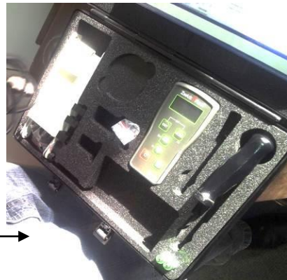
Slika 6. Stabilni i prenosni uređaj za merenje tvrdoće ZWICH ROELL ZHU 2.5 i Microdur MIC 10a
