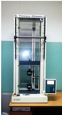
Slika 5. Mehanička mašina za dinamička i statička ispitivanja TINIUS OLSEN H10KS sa primerom reprezentativnih ispitivanja
